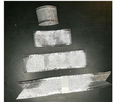
12 auf dem Basisband beidseitiges Klebeband in der Mitte anbringen.
